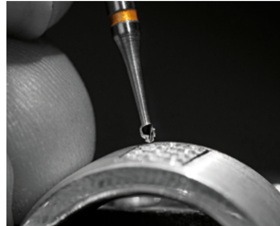
Arbeits erleichterung und Zeitersparnis: Der „Pavé-Cut 447AU“ kombiniert Spiral- und Rundbohrer in einem Werkzeug.
